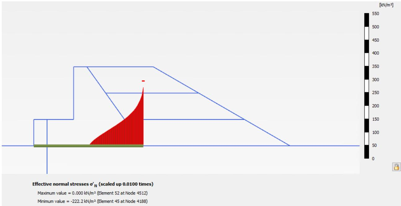
Figure 42 : Contraintes normales effectives à l'interface barrage-fondation à RN + glace
